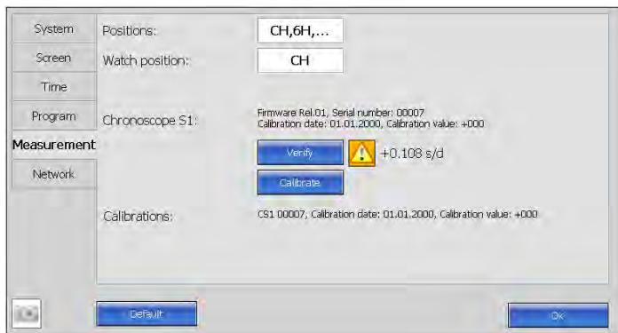
Pulse el botón **Verificar** para comprobar la precisión de la base de tiempo del dispositivo.
