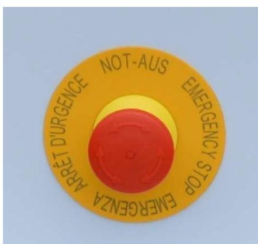
Se utiliza para detener rápidamente el motor del dispositivo en caso de peligro o para evitar un peligro potencial.
