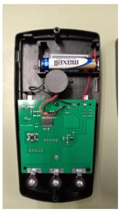
3. Ya podemos sustituir la pila de LR6 1.5V AA.
