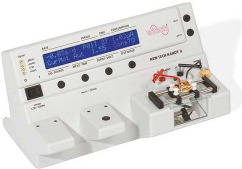
Aparato para el control de la marcha, del consumo y de los componentes de los relojes de cuarzo. El relojero necesita un equipo que pueda utilizar en el servicio de reparación y el laboratorio relojero que le permita efectuar todas las mediciones y pruebas eléctricas en los relojes de cuarzo. Este aparato ofrece todas las posibilidades de control y de test requeridos para la búsqueda profesional de defectos en relojes de cuarzo.
