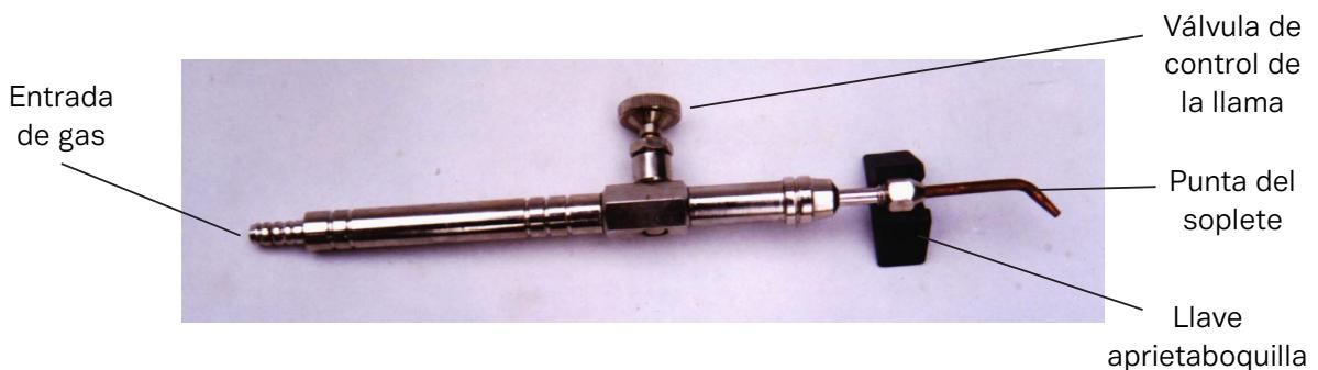
**Cuerpo del soplete:** Utilice la boquilla apropiada para el caudal de gas que precise según el trabajo a realizar. Ajuste el flujo de gas y la llama (gire en el sentido de las agujas del reloj para cerrar).
